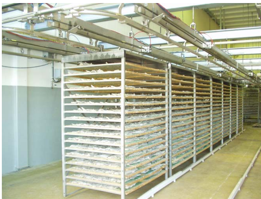
Figur 2. Bilde av hengende reoler ved langblåst tørke fra Optimar. Disse reolene inneholder ferdig klippfisk, og de er kjørt ut av tunnelen og står på vent for tømning av brettene, som foregår automatisk.
